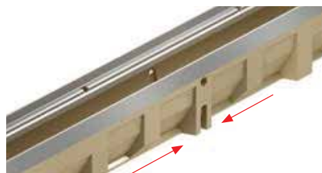
Liaison en T (2 x 90°) par les sorties préformées latérales (sur les deux côtés) avec l'élément de 0,5
