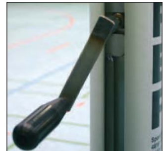
Kurbel zur Höhenverstellung und zur Netzspannung.
