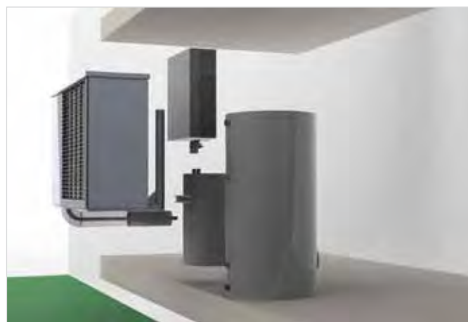
Exemple d'un montage pompe à chaleur Air/Eau LWD
