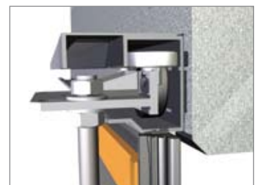
Laufschienenprofil auf Laibung - running rail profile – on embrasure
