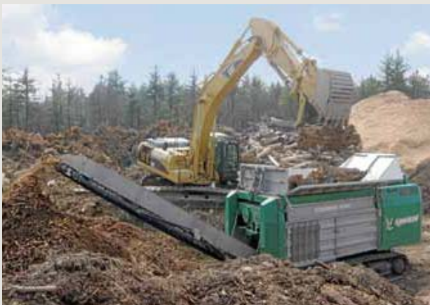
Langsamlaufender Zweiwellen-Hochleistungszerkleinerer für Altholz, Grünschnitt und Wurzelstöcke Broyeur à deux arbres à basse vitesse pour bois de récupération, déchets végétaux et souches Trituratore bialbero a bassa velocità per legno usato, arbusti, rifiuti vegetali e bastoni di radici
