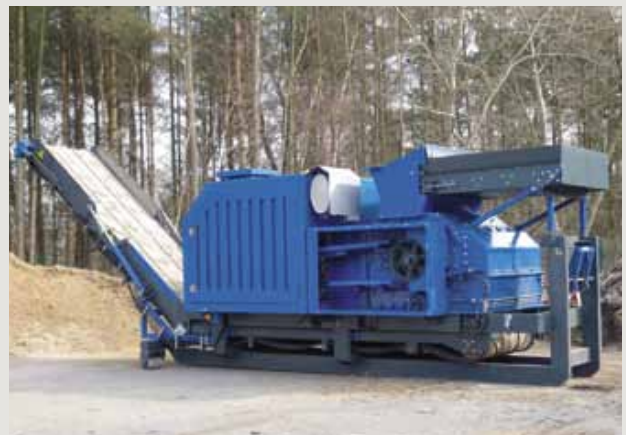
Nachzerkleinerung zur Holzschnitzelproduktion, mit austauschbaren Siebeinheiten Après broyage pour production de copeaux de bois, avec des tamis échangeables Triturazione per produzione di minuzzolo di legno, con vagli sostituibili
