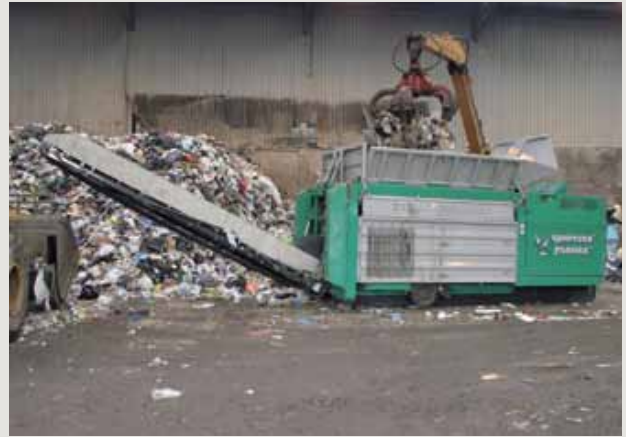
Mobile langsamlaufende Einwellen-Universalzerkleinerungsmaschine für Sperrmüll, Kabel- und Elektronikschrott Broyeur universel mono-rotor mobile à basse vitesse, pour déchets encombrants, câbles et ferrailles électriques Trituratore monoalbero universale mobile a bassa velocità, per rifiuti ingombranti cavi e rottami elettronici
