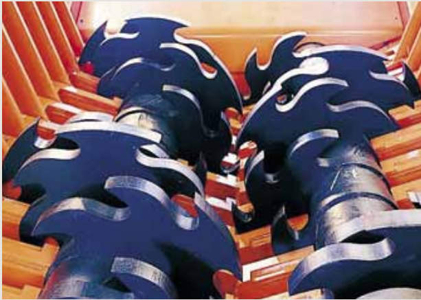
Zweiwellenzerkleinerer für Sperrgut, Holz, Bauabfälle und Hauskehricht Broyeur à deux arbres pour déchets encombrants, bois, déchets de construction et ordures ménagères Trituratore bialbero per rifiuti ingombranti, legna, residui di costruzioni, e rifiuti domestici
